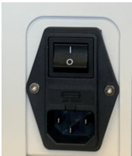
Figura 4. Interruptor y alimentación eléctrica.
