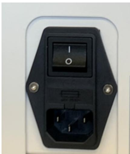
Figure 4. Interrupteur et alimentation électrique.
