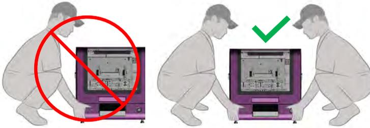
Figura 17. Correct lifting and carrying of the device (Correcta elevación y transporte del dispositivo).
