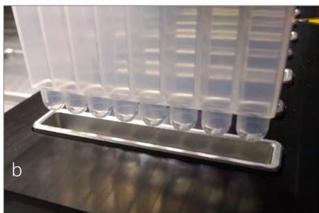
El instrumento funciona con hasta seis tiras de lisis insertadas. Coloque las tiras de lisis en sus posiciones correspondientes en el bloque calefactor. Los surcos en los laterales de las tiras facilitan su correcta orientación durante la extracción y deben estar orientados hacia la izquierda.
