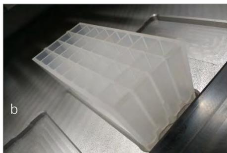
El instrumento funciona con hasta seis bloques de 32 pocillos insertados. Coloque los bloques de 32 pocillos en sus posiciones correspondientes en el IndiMag 2. Los surcos en los laterales de los bloques facilitan su correcta orientación durante la extracción.
