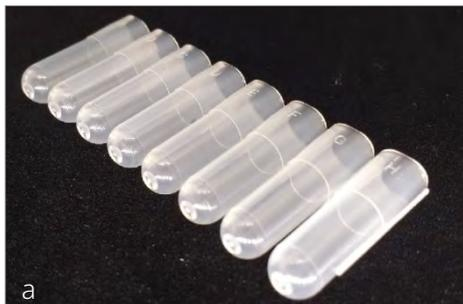
La tira de elución permite la elución simultánea de 8 muestras. Se permiten volúmenes de procesamiento entre 50  $\mu\text{l}$  y 200  $\mu\text{l}$ . Si no se respetan los límites de volumen de procesamiento, no se puede garantizar un rendimiento adecuado y se puede producir contaminación cruzada.
