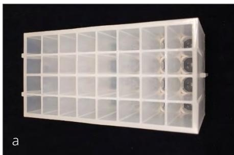
El bloque de 32 pocillos permite la extracción simultánea de 8 muestras. Se permiten volúmenes de procesamiento entre 100  $\mu\text{l}$  y 1000  $\mu\text{l}$ . Si no se respetan los límites de volumen de procesamiento, no se puede garantizar un rendimiento adecuado y se puede producir contaminación cruzada.
