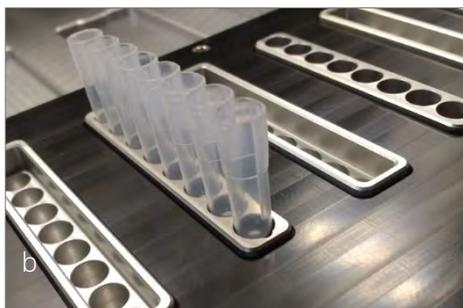
El instrumento funciona con hasta seis tiras de elución insertadas. Coloque las tiras de elución en sus posiciones correspondientes en el bloque calefactor. Los surcos en los laterales de las tiras facilitan su correcta orientación durante la extracción y deben estar orientados hacia abajo.
