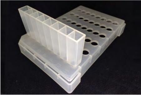
Para facilitar el preprocesamiento, se recomienda el uso de gradillas de lisis. La gradilla de lisis tiene capacidad para hasta seis tiras de lisis. La orientación de las tiras de lisis es fija y se alinea con la orientación de las tiras de lisis dentro del IndiMag 2. Las tiras de lisis deben colocarse de manera que los surcos se orienten hacia la izquierda.
