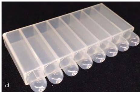
La tira de lisis permite la lisis simultánea de 8 muestras. Se permiten volúmenes de procesamiento entre 100 µl y 1000 µl. Si no se respetan los límites de volumen de procesamiento, no se puede garantizar un rendimiento adecuado y se puede producir contaminación cruzada.
