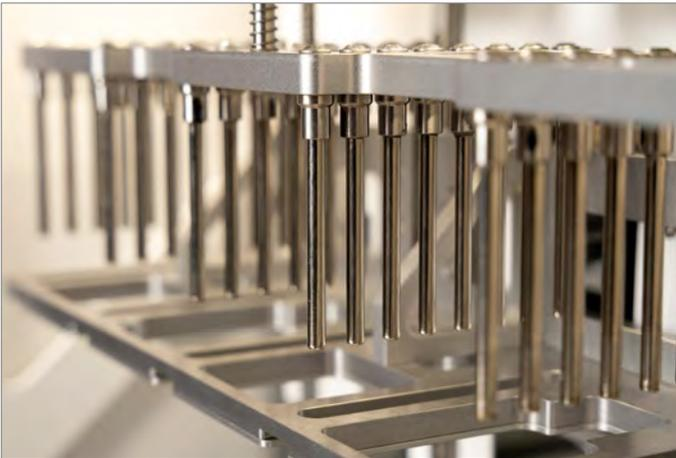
Figura 7. Magnet rods and magnet rod cover table (Tabla de las barras magnéticas y de la cubierta de la barra magnética).
