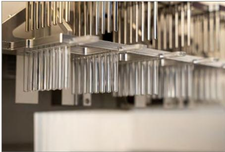
Las cubiertas de las barras se deben insertar completamente en las ranuras designadas en la tabla de la cubierta de la barra. El IndiMag 2 funciona con hasta seis cubiertas de barras. Para que comience la extracción se debe insertar al menos una cubierta de barra.
