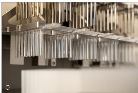
As coberturas de hastes devem ser completamente inseridas nas respetivas ranhuras da mesa de coberturas de hastes. O IndiMag 2 funciona com um máximo de seis coberturas de hastes. É necessário que, pelo menos, uma cobertura de haste esteja inserida para iniciar a extração.
