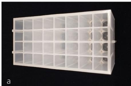
O bloco de 32 poços permite a extração simultânea de 8 amostras. São permitidos volumes de processamento entre 100  $\mu\text{l}$  e 1000  $\mu\text{l}$ . Se os limites do volume de processamento não forem respeitados, não é possível garantir um desempenho adequado e pode ocorrer contaminação cruzada.
