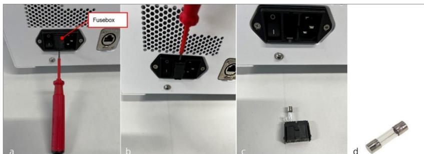
Figura 34. Substituir o fusível principal.
