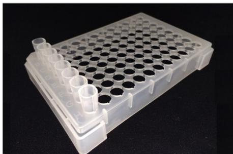
Para um armazenamento conveniente, recomenda-se a utilização de racks de armazenamento da eluição. O rack de armazenamento da eluição comporta até doze tiras de eluição para armazenamento.
