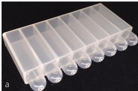
A tira de lise permite a lise simultânea de 8 amostras. São permitidos volumes de processamento entre 100  $\mu\text{l}$  e 1000  $\mu\text{l}$ . Se os limites do volume de processamento não forem respeitados, não é possível garantir um desempenho adequado e pode ocorrer contaminação cruzada.
