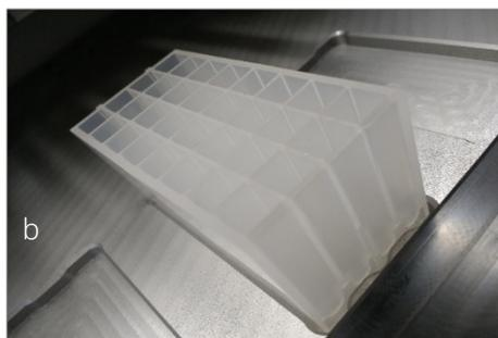
O instrumento funciona com um máximo de seis blocos de 32 poços inseridos. Coloque os blocos de 32 poços nas respectivas posições específicas no IndiMag 2. Os sulcos laterais dos blocos facilitam a orientação correta durante a extração.
