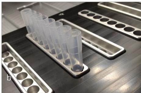
O instrumento funciona com um máximo de seis tiras de eluição inseridas. Coloque as tiras de eluição nas respetivas posições específicas no bloco de aquecimento. Os sulcos laterais das tiras facilitam a orientação correta durante a extração e devem ficar voltados para baixo para a esquerda.
