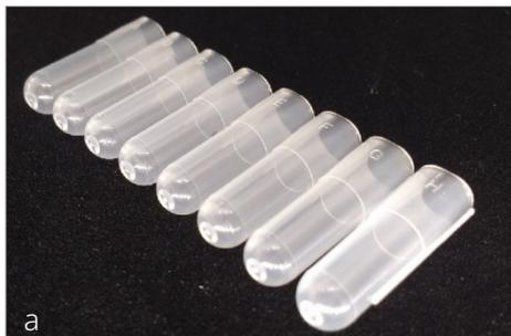
A tira de eluição permite a eluição simultânea de 8 amostras. São permitidos volumes de processamento entre 50 µl e 200 µl. Se os limites do volume de processamento não forem respeitados, não é possível garantir um desempenho adequado e pode ocorrer contaminação cruzada.
