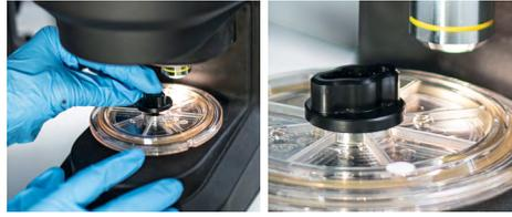
Placer la cassette dans l'analyseur OvaCyte et démarrer le scan. Le scan, l'analyse et la création du rapport sont entièrement automatisés. Le logiciel de reconnaissance d'images alimenté par l'IA identifie chaque espèce de parasite à l'aide de la base de données et compte les oeufs ou oocystes parasitaires présents dans l'échantillon.
