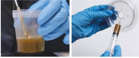
Peser la matière fécale, homogénéiser avec le liquide de flottaison fourni et filtrer la solution à travers le filtre fourni. Remplir la cassette avec la solution filtrée.
